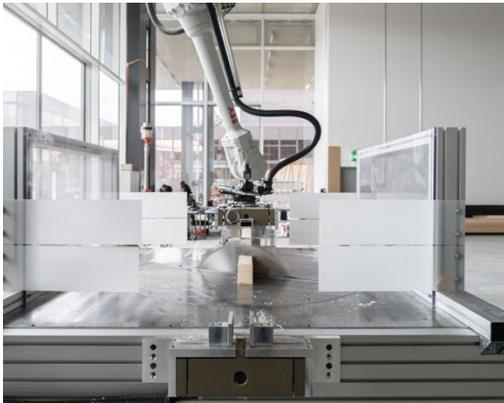
Ein Roboter führt einen Holzbalken der Säge für den Zuschnitt zu.
